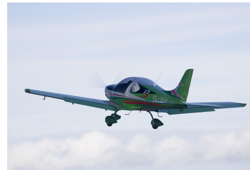
Il DW200 in decollo: in evidenza la pulizia delle linee e i flap estesi per due terzi dell'apertura
