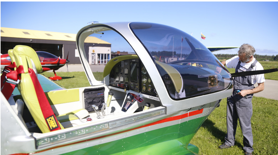
Il canopy scorre in avanti su due binari per l'accesso a bordo
